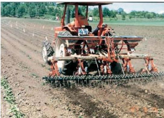
写真IV-2 スプリング式ウィーダによる除草機
