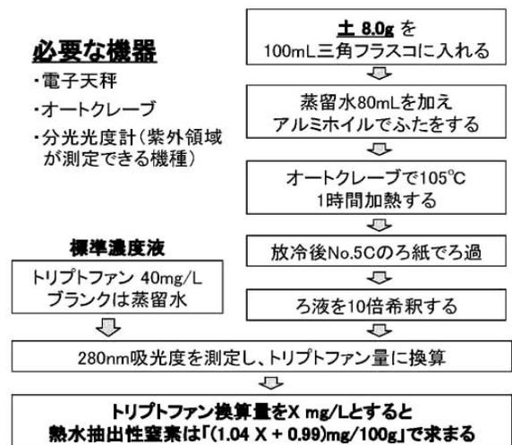
図VII-4 熱水抽出性窒素の簡易分析法 (中辻ら、2007)<sup>13)</sup>
