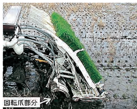
図Ⅱ－35 不耕起田植機(植付部分のみ耕す回転爪がついている)
