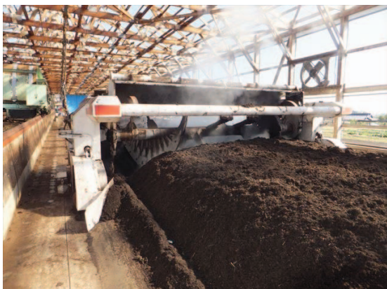
(写真) ロータリー攪拌で一次発酵を実施
