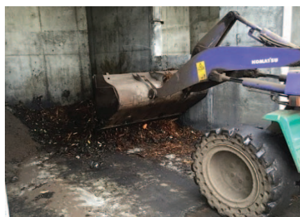
(写真) シャベルローダーによる攪拌
